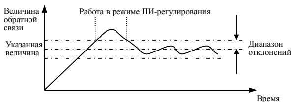
Рисунок 6-27. График с указанием диапазона отклонений
