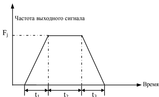
Рисунок 6-11. Рабочая частота импульсного режима и время разгона/замедления
