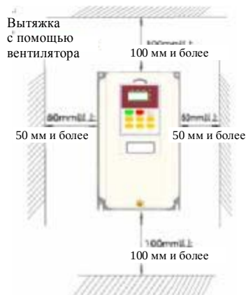
Рисунок 3-1. Пространство, требующееся для установки преобразователя
