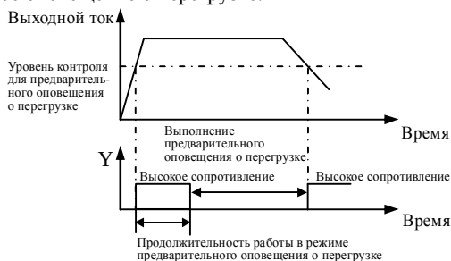
Рисунок 6-18. Графики работы в режиме предварительного оповещения о перегрузке
