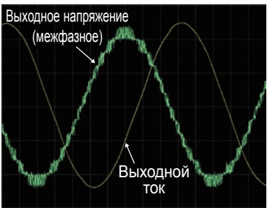
Кривые тока и напряжения на выходе для ПЧ 3 кВ
